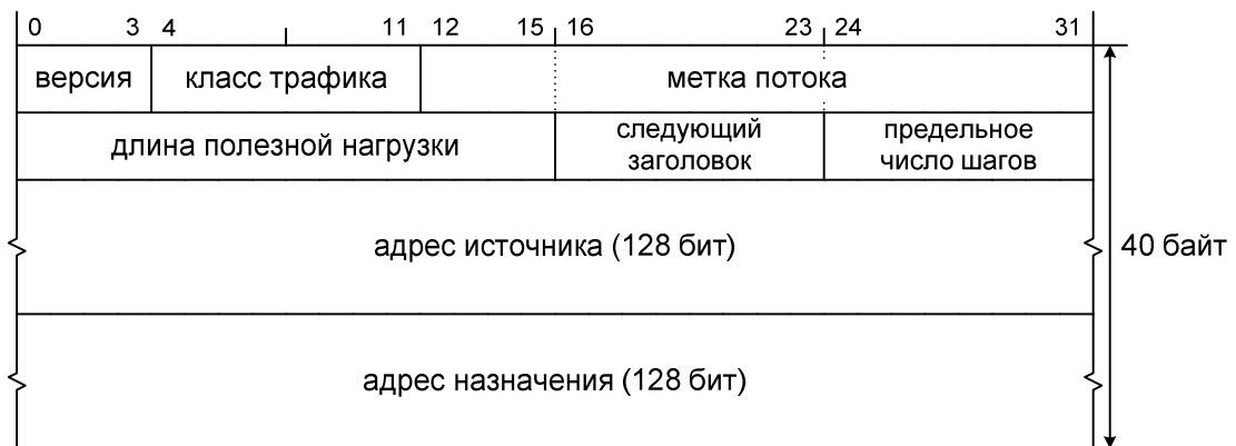
Фиг. 26. Основной заголовок IPv6
