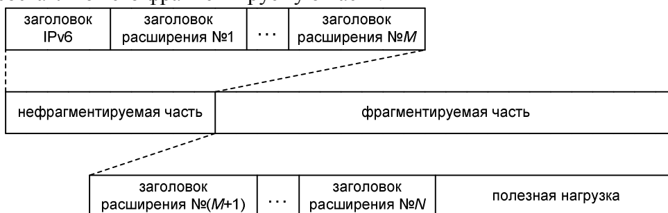
Фиг. 35. Структура пакета IPv6 с точки зрения его фрагментации
